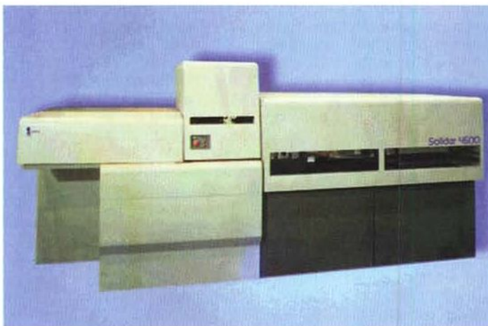
Ecco il Cubital Solider 4600. Il computer di processo comunemente utilizzato è una workstation Indy della Silicon Graphics.
